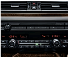
Climatisation automatique 2 zones à fonctionnalités étendues avec recyclage automatique de l'air AUC, filtre pour air recyclé, capteurs de buée et d'ensoleillement, régulation automatique de la température (individuelle pour le conducteur et le passager avant), régulation du débit, affichage et commande via l'écran de contrôle.
