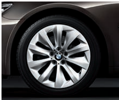
Jantes en alliage léger 19" (48 cm) style 357 Aero avec monte pneumatique mixte. Dimensions : 8,5 J x 19 à l'avant, pneumatiques 245/45 R 19 Y, 9,5 J x 19 à l'arrière, pneumatiques 275/40 R 19 Y.
