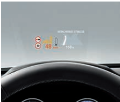
Affichage Tête Haute HUD couleur. Il projette directement dans le champ visuel du conducteur des informations relatives à la conduite, comme par exemple la vitesse 2 . L'affichage en couleur permet de consulter ces données avec encore plus de précision et de rapidité.
