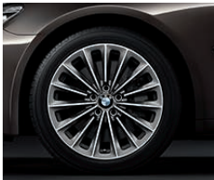
Jantes en alliage léger forgé 19" (48 cm) style 252 à rayons radiaux avec monte pneumatique mixte. Dimensions : 8,5 J x 19 à l'avant, pneumatiques 245/45 R 19 Y, 9,5 J x 19 à l'arrière, pneumatiques 275/40 R 19 Y.
