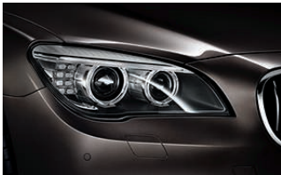
Projecteurs directionnels avec feux de route permanents anti-éblouissement « BMW Selective Beam ».
