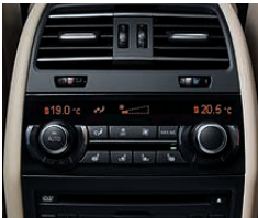
Climatisation automatique 4 zones à fonctionnalités étendues. Comme ci-contre avec, en plus, réglage individuel de la température à l'arrière via deux molettes et affichage indépendant. Comprend également une ventilation et des aérateurs de bas d'habitacle à l'arrière (de série sur Limousine, 760i et ActiveHybrid 7).
