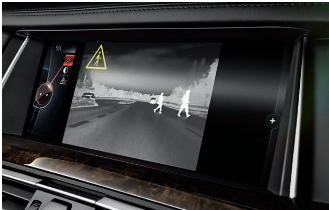
Système de vision nocturne BMW « Night Vision » avec éclairage dynamique des piétons « Dynamic Light Spot ».
