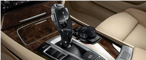
Boîte de vitesses automatique à 8 rapports avec fonction d'arrêt et de redémarrage automatique du moteur 1 . Sélection électronique des rapports, boîte auto-adaptative pour une conduite détendue et efficiente (ici représentée avec option applications en céramique). En mode manuel, l'indicateur de changement de rapport est activé.
