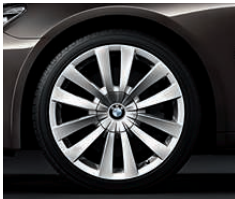
Jantes en alliage léger 20" (51 cm) style 253 à rayons doubles avec monte pneumatique mixte. Dimensions : 8,5 J x 20 à l'avant, pneumatiques 245/40 R 20 Y, 10 J x 20 à l'arrière, pneumatiques 275/35 R 20 Y.
