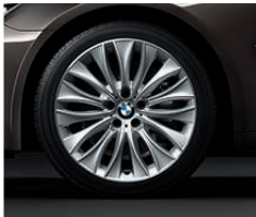
Jantes en alliage léger 20" (51 cm) style 459 à rayons multiples avec monte pneumatique mixte. AV / AR 8,5 / 10 J x 20, pneumatiques AV / AR 245/40 / 275/35 R 20.
