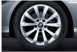
□ Jantes en alliage léger 1 17" (43 cm) style 285 à rayons en V , 8 J x 17, pneumatiques RSC permettant le roulage à plat 225/45 R 17 (de série sur les BMW 325i xDrive, 330i, 330i xDrive, 335i, 335i xDrive, 325d, 330d, 330d xDrive et 335d).
