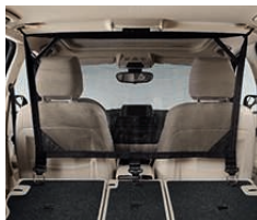
Filet de séparation du coffre empêchant la projection d'objets dans l'habitacle en cas de freinage brusque. Cet équipement comprend deux filets de protection, avec crochets et sangle d'arrimage, à utiliser selon la position de la banquette arrière.
