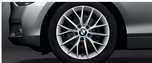
Jantes en alliage léger 17" (43 cm) style 380 à rayons en Y. Dimensions : 7 J x 17, pneumatiques 205/50 R 17 (de série sur BMW 125i et 125d).
