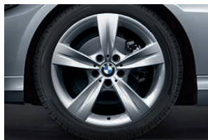
□ Jantes en alliage léger 18" (46 cm) style 287 à rayons en étoile, avec monte pneumatique mixte RSC permettant le roulage à plat. Dimensions : 8 J x 18 à l'avant, pneumatiques 225/40 R 18 ; 8,5 J x 18 à l'arrière, pneumatiques 255/35 R 18.
