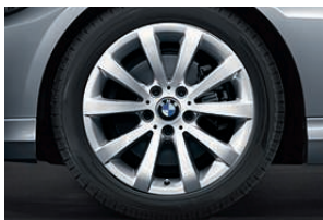
□ Jantes en alliage léger 17" (43 cm) style 285 à rayons en V, 8 J x 17, pneumatiques RSC permettant le roulage à plat 225/45 R 17. De série sur les BMW 330i, 330i xDrive, 335i, 335i xDrive, 325d, 330d, 330d xDrive et 335d.
