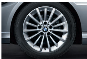
□ Jantes en alliage léger 17" (43 cm) style 284 à rayons multiples, 8 J x 17, pneumatiques RSC permettant le roulage à plat 225/45 R 17.
