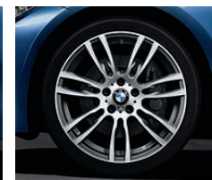
Jantes en alliage léger 19" (48 cm) style 403 M à rayons doubles en « Ferricrau » bicolore, polies, avec monte pneumatique mixte. Dimensions : 8 J x 19 à l'avant, pneumatiques 225/40 R 19 ; 8,5 J x 19 à l'arrière, pneumatiques 255/35 R 19.
