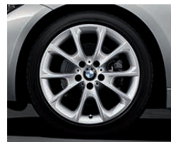
Jantes en alliage léger 18" (46 cm) style 398 à rayons en V avec monte pneumatique mixte. Dimensions : 8 J x 18 à l'avant, pneumatiques 225/45 R 18 ; 8,5 J x 18 à l'arrière, pneumatiques 225/40 R 18.
