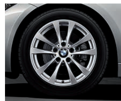
Jantes en alliage léger 17" (43 cm) style 395 à rayons en V avec monte pneumatique mixte. Dimensions : 7,5 J x 17, pneumatiques 225/50 R 17 ; 8,5 J x 17 à l'arrière, pneumatiques 225/45 R 17.
