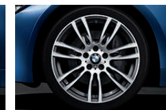
Jantes en alliage léger 19" (48 cm) style 403 M à rayons doubles en « Ferricgrau » bicolor, polies, avec pneumatiques RSC permettant le roulage à plat et monte pneumatique mixte. Dimensions : 8 J x 19 à l'avant, pneumatiques 225/40 R 19 ; 8,5 J x 19 à l'arrière, pneumatiques 255/35 R 19.
