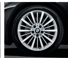
Jantes en alliage léger 18" (46 cm) style 416 à rayons multiples, polies. Dimensions : 8 J x 18, pneumatiques 225/45 R 18 (uniquement avec la Finition Luxury, de série sur BMW 328i, 335i, 325d, 330d et 335d xDrive).
