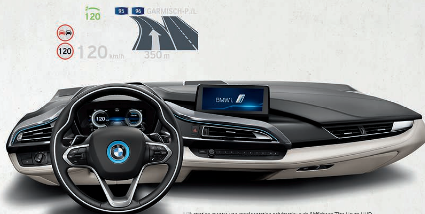
L'illustration montre une représentation schématique de l'Affichage Tête Haute HUD.
