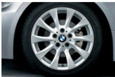
□ Jantes BMW en alliage léger style turbine 201 , 8 J x 17 pouces, pneumatiques 225/45 R17.
