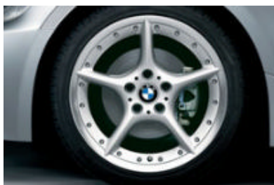
□ Jantes BMW en alliage léger style 108 à rayons en étoile , en deux parties boulonnées avec monte pneumatique mixte ; dimensions à l'avant : 8 J x 18 pouces, pneumatiques 225/40 R18 ; dimensions à l'arrière : 8,5 J x 18 pouces, pneumatiques 255/35 R18.
