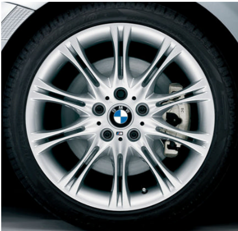
□ Jantes BMW en alliage léger style 135M à rayons doubles , avec monte pneumatique mixte ; dimensions à l'avant : 8 J x 18 pouces, pneumatiques 225/40 R18 ; dimensions à l'arrière : 8,5 J x 18 pouces, pneumatiques 255/35 R18.
