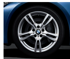
Jantes en alliage léger 18" (46 cm) style 400 M à rayons doubles avec monte pneumatique mixte. Dimensions : 8 J x 18 à l'avant, pneumatiques 225/45 R 18 ; 8,5 J x 18 à l'arrière, pneumatiques 255/40 R 18 (uniquement avec la Finition M Sport, de série).
