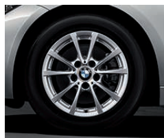
Jantes en alliage léger 16" (41 cm) style 390 à rayons en V. Dimensions : 7 J x 16, pneumatiques 205/60 R 16 (de série sur BMW 316i, 316d, 318d, 320i et 320d).
