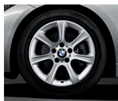
Jantes en alliage léger 17" (43 cm) style 394 à rayons en étoile. Dimensions : 7,5 J x 17, pneumatiques 225/50 R 17 (de série sur BMW 328i, 335i, 325d et 330d).
