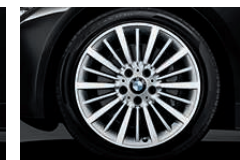
Jantes en alliage léger 18" (46 cm) style 416 à rayons multiples, polies, avec pneumatiques RSC permettant le roulage à plat. Dimensions : 8 J x 18, pneumatiques 225/45 R 18 (de série sur BMW 328i, 335i, 325d et 330d).
