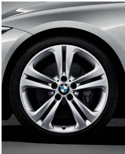
Jantes en alliage léger 19" (48 cm) style 401 à rayons doubles avec monte pneumatique mixte. Dimensions : 8 J x 19 à l'avant, pneumatiques 225/40 R 19 ; 8,5 J x 19 à l'arrière, pneumatiques 255/35 R 19.
