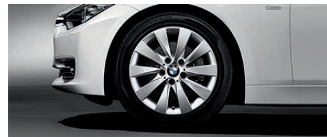
Jantes en alliage léger 17" (43 cm) style 413 à rayons en V. Dimensions : 7,5 J x 17, pneumatiques 225/50 R 17 (uniquement avec la Finition Modern, de série sur BMW 316i, 320i, 316d, 318d et 320d).
