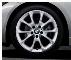
Jantes en alliage léger 18" (46 cm) style 398 à rayons en V avec monte pneumatique mixte. Dimensions : 8 J x 18 à l'avant, pneumatiques 225/45 R 18 ; 8,5 J x 18 à l'arrière, pneumatiques 255/40 R 18.
