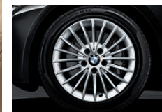
Jantes en alliage léger 17" (43 cm) style 414 à rayons multiples avec pneumatiques RSC permettant le roulage à plat. Dimensions : 7,5 J x 17, pneumatiques 225/50 R 17 (de série sur BMW 316i, 320i, 316d, 318d et 320d).
