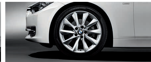
Jantes en alliage léger 18" (46 cm) style 415 turbine. Dimensions : 8 J x 18, pneumatiques 225/45 R 18 (uniquement avec la Finition Modern, de série sur BMW 328i, 335i, 325d et 330d).
