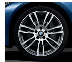
Jantes en alliage léger 19" (48 cm) style 403 M à rayons doubles en « Ferricgrau » bicolore, polies, avec monte pneumatique mixte. Dimensions : 8 J x 19 à l'avant, pneumatiques 225/40 R 19 ; 8,5 J x 19 à l'arrière, pneumatiques 255/35 R 19. 1
