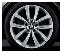
Jantes en alliage léger 19" (48 cm) style 331 à rayons en V , avec monte pneumatique mixte RSC permettant le roulage à plat. Dimensions : 8,5 J x 19 à l'avant, pneumatiques 245/40 R 19 ; 9 J x 19 à l'arrière, pneumatiques 275/35 R 19.
