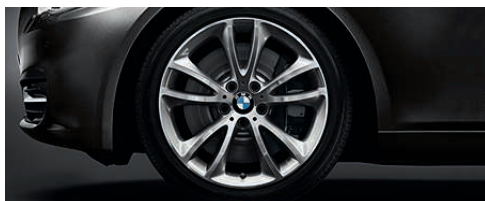
Jantes en alliage léger 19" (48 cm) style 366 à rayons en V , avec monte pneumatique mixte RSC permettant le roulage à plat. Dimensions : 8,5 J x 19 à l'avant, pneumatiques 245/40 R 19 ; 9 J x 19 à l'arrière, pneumatiques 275/35 R 19.
