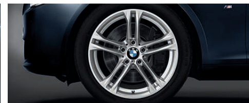
Jantes en alliage léger 18" (46 cm) style 613 M à rayons doubles , avec monte pneumatique mixte RSC permettant le roulage à plat. Dimensions : 8 J x 18 à l'avant, pneumatiques 245/45 R 18 ; 9 J x 18 à l'arrière, pneumatiques 275/40 R 18. De série sur la Finition M Sport.
