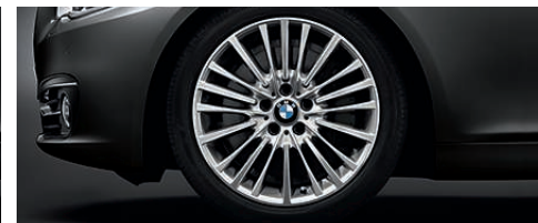
Jantes en alliage léger 19" (48 cm) style 455 à rayons multiples , avec monte pneumatique mixte RSC permettant le roulage à plat. Dimensions : 8,5 J x 19 à l'avant, pneumatiques 245/40 R 19 ; 9 J x 19 à l'arrière, pneumatiques 275/35 R 19.
