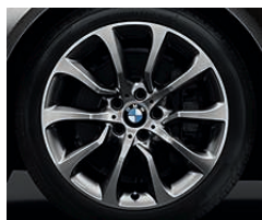
Jantes en alliage léger 19" (48 cm) style 453 turbine , « Ferricgrau » bicolores, avec monte pneumatique mixte RSC permettant le roulage à plat. Dimensions : 8,5 J x 19 à l'avant, pneumatiques 245/40 R 19 ; 9 J x 19 à l'arrière, pneumatiques 275/35 R 19.
