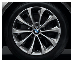
Jantes en alliage léger 18" (46 cm) style 452 turbine , « Ferricgrau » bicolores, avec pneumatiques RSC permettant le roulage à plat. Dimensions : 8 J x 18, pneumatiques 245/45 R 18.
