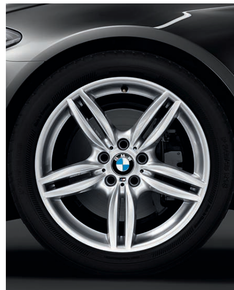
Jantes en alliage léger 19" (48 cm), style 351 M à rayons doubles avec pneumatiques RSC permettant le roulage à plat. Dimensions : 8,5 J x 19, pneumatiques 245/40 R 19. De série sur BMW M550d xDrive.
