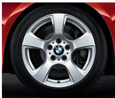
■ Jantes en alliage léger 17" (43 cm) style 157 à rayons en étoile , 8 J x 17, pneumatiques 225/45 R 17 (de série sur les BMW 320i, 320d et 320d xDrive).
