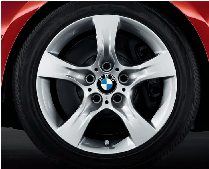
□ Jantes en alliage léger 17" (43 cm) style 339 à rayons en étoile , 8 J x 17, pneumatiques 225/45 R 17 (de série sur les BMW 325i, 325i xDrive et 325d).
