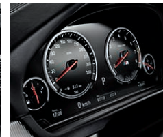
Combiné d'instrumentation « Black Panel » avec graduation blanche permanente et aiguilles rouges pour l'indicateur de vitesse et le compte-tours, ainsi qu'un affichage pour les systèmes spécifiques M, la boîte de vitesses M DKG, le point de passage des rapports et la température de l'huile.
