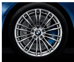
Jantes en alliage léger 19" (48 cm) style 345 M à rayons doubles , avec monte pneumatique mixte. Dimensions : 9 J x 19 à l'avant, pneumatiques 265/40 R 19 ; 10 J x 19 à l'arrière, pneumatiques 295/35 R 19.
