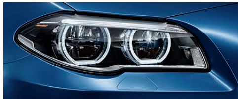
Projecteurs Full LED pour feux de croisement et feux de route, avec feux de route permanents anti-éblouissement « BMW Selective Beam », projecteurs directionnels, éclairage d'intersection, répéteurs de clignotant et bande lumineuse à LED. Émettant une lumière naturelle dont la couleur est proche de celle du jour, les LED assurent un éclairage particulièrement clair. Ce dernier est diffusé par les quatre anneaux lumineux, ce qui concourt à rendre les projecteurs inimitables de jour comme de nuit.
