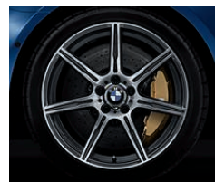
Jantes en alliage léger 20" (51 cm) style 601 M à rayons doubles , bicolores, polies, avec monte pneumatique mixte. Dimensions : 9 J x 20 à l'avant, pneumatiques 265/35 R 20 ; 10 J x 20 à l'arrière, pneumatiques 295/30 R 20 (uniquement en combinaison avec le Pack Compétition).
