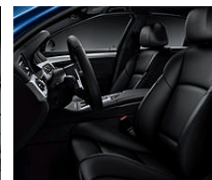
Sièges avant Sport M avec coutures M, flancs et dossiers plus prononcés ; réglage électrique du dossier, de la position longitudinale, de la hauteur d'assise, de l'inclinaison du siège, de la largeur du dossier et de la longueur d'assise, fonction mémoire côté conducteur.
