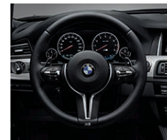
Volant M gainé cuir avec palettes de changement de rapport, touches multifonctions et deux touches M Drive.
