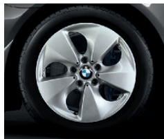
Jantes en alliage léger 17" (43 cm) style 363 Aero avec pneumatiques RSC permettant le roulage à plat. Dimensions : 8 J x 17, pneumatiques 225/55 R 17. Série sur BMW 520d EfficientDynamics Edition et BMW ActiveHybrid 5.
