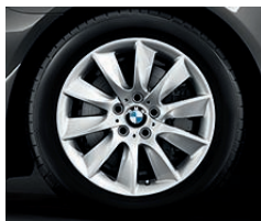
Jantes en alliage léger 18" (46 cm) style 329 turbine avec monte pneumatique mixte RSC permettant le roulage à plat. Dimensions : 8 J x 18, pneumatiques 245/45 R 18 à l'avant ; 9 J x 18, pneumatiques 275/40 R 18 à l'arrière. Indisponibles sur BMW 520d EfficientDynamics Edition.
