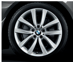
Jantes en alliage léger 19" (48 cm) style 331 à rayons en W avec monte pneumatique mixte RSC permettant le roulage à plat. Dimensions : 8,5 J x 19, pneumatiques 245/40 R 19 à l'avant ; 9 J x 19, pneumatiques 275/35 R 19 à l'arrière. Indisponibles sur BMW 520d EfficientDynamics Edition.
