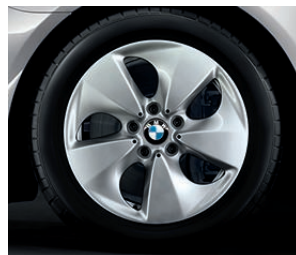
Jantes en alliage léger 17" (43 cm) style 363 Aero, 8 J x 17, pneumatiques 225/55 R 17.
