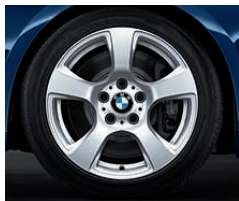
■ Jantes en alliage léger 17" (43 cm) style 157 à rayons en étoile , 8 J x 17, pneumatiques 225/45 R 17 (de série sur les BMW 320i et 320d).
