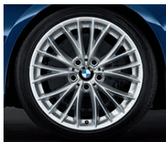
□ Jantes en alliage léger 18" (46 cm) style 342 à rayons en V , avec monte pneumatique mixte. Dimensions 8 J x 18 à l'avant, pneumatiques 225/40 R 18 ; 8,5 J x 18 à l'arrière, pneumatiques 255/35 R 18.
