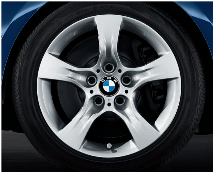
□ Jantes en alliage léger 17" (43 cm) style 339 à rayons en étoile , 8 J x 17, pneumatiques 225/45 R 17 (de série sur les BMW 325i et 325d).
