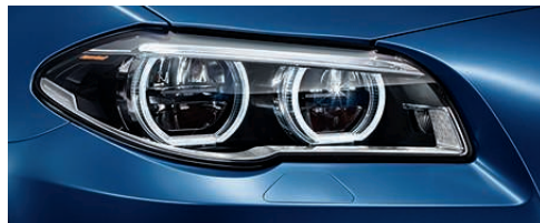
Projecteurs Full LED pour feux de croisement et feux de route, avec feux de route permanents anti-éblouissement, projecteurs directionnels, éclairage d'intersection, répéteurs de clignotant et bande lumineuse à LED. Émettant une lumière naturelle dont la couleur est proche de celle du jour, les LED assurent un éclairage particulièrement clair. Ce dernier est diffusé par les quatre anneaux lumineux, ce qui concourt à rendre les projecteurs inimitables de jour comme de nuit.
