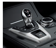
Sélecteur de boîte automatique pour la boîte de vitesses à 7 rapports M DKG à double embrayage avec Drivelogic. Avec logo M, rétro-éclairage et touches dynamiques.
