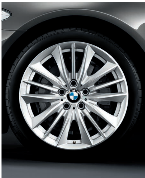
Jantes en alliage léger 19" (48 cm) style 332 à rayons en W avec pneumatiques RSC permettant le roulage à plat. Dimensions : 8,5 J x 19, pneumatiques 245/40 R 19.
