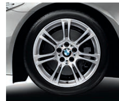
Jantes en alliage léger 18" (46 cm) style 350 M à rayons doubles, 8 J x 18, 245/45 R 18.
