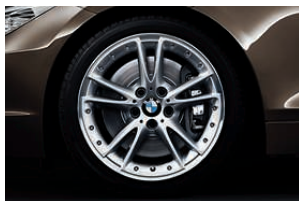
□ Jantes en alliage léger 18" (46 cm) style 294 à rayons en V , structure composite vissée, avec monte pneumatique mixte RSC permettant le roulage à plat. Dimensions : 8 J x 18 à l'avant, pneumatiques 225/40 R 18 ; 8,5 J x 18 à l'arrière, pneumatiques 255/35 R 18.
