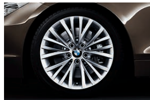
□ Jantes en alliage léger 18" (46 cm) style 293 à rayons multiples , avec monte pneumatique mixte RSC permettant le roulage à plat. Dimensions : 8 J x 18 à l'avant, pneumatiques 225/40 R 18 ; 8,5 J x 18 à l'arrière, pneumatiques 255/35 R 18.
