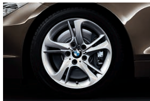
□ Jantes en alliage léger 17" (43 cm) style turbine 292 , avec monte pneumatique mixte RSC permettant le roulage à plat. Dimensions : 8 J x 17 à l'avant, pneumatiques 225/45 R 17 ; 8,5 J x 17 à l'arrière, pneumatiques 255/40 R 17 (de série sur Z4 sDrive35i).
