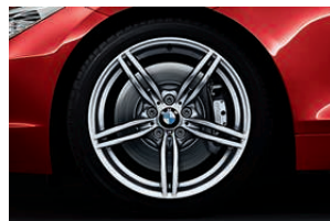
□ Jantes en alliage léger 19" (48 cm) style 326 M 1,2 à rayons doubles avec monte pneumatique mixte RSC permettant le roulage à plat. Dimensions : 8 J x 19 à l'avant, pneumatiques 225/35 R 19 ; 9 J x 19 à l'arrière, pneumatiques 255/30 R 19.
