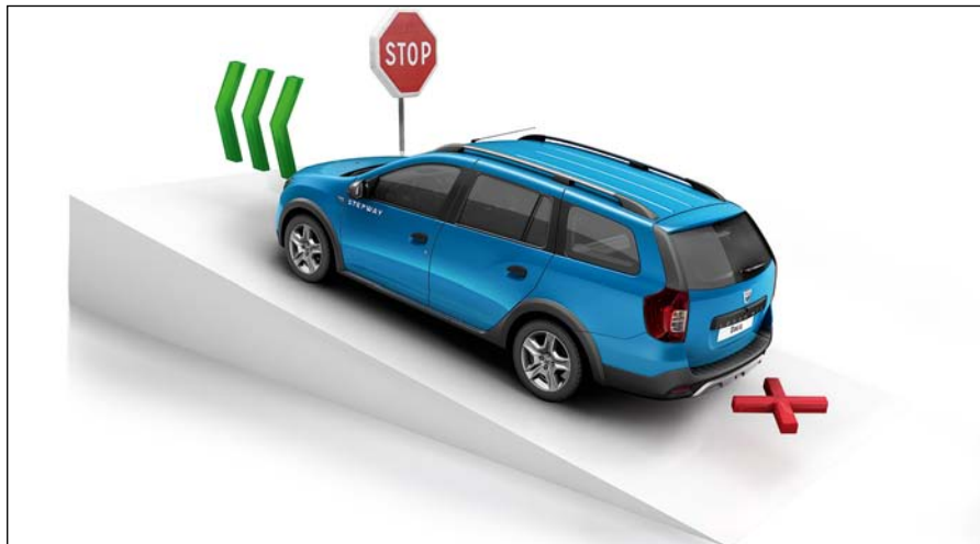
Aide au démarrage en côte : Ce système vous aide à démarrer en côte en toute sécurité et sans précipitation.
