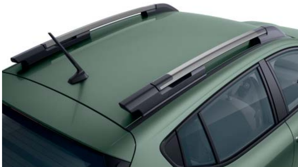
BARRES TOIT LONGITUDINALES
