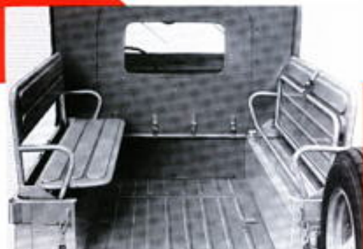
Détail des banquettes latérales
