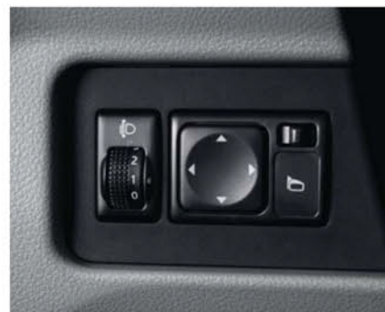
Commande électrique des rétroviseurs et du réglage en hauteur des phares
