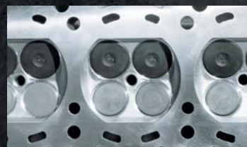
LE REFROIDISSEMENT des soupapes a été amélioré grâce à l'utilisation de sodium.
